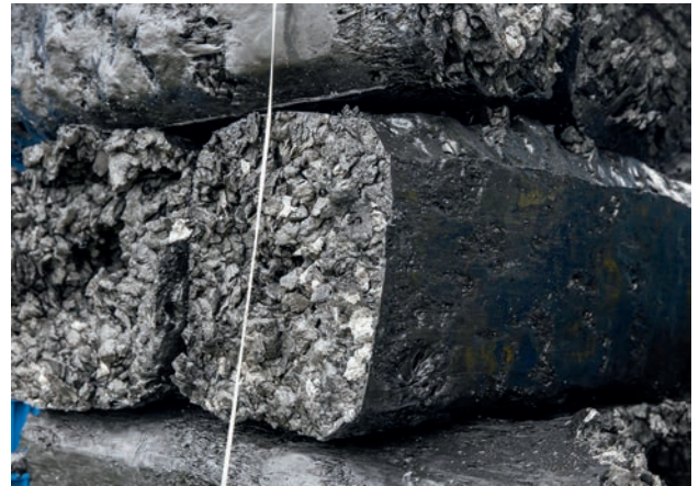
Bild 2. Die ausgemusterten Ladungsträger werden gesammelt, verdichtet und anschließend zu Granulat verarbeitet (© JSP)
